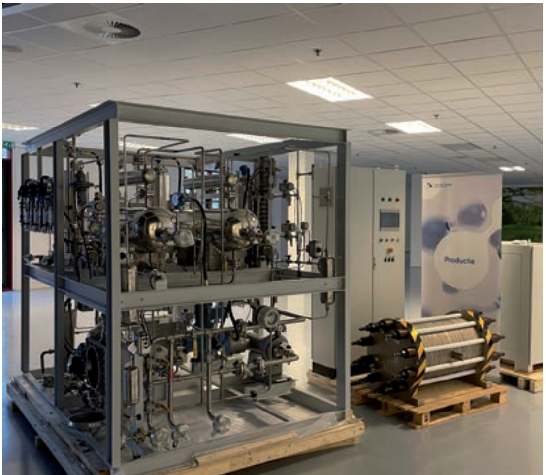
► Electrolyser stack 70 KW / 1,3 kg H 2 per uur.
