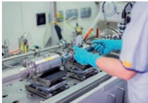
▶ Echtgas (waterstof) kalibratiesysteem met Massa Flowmeter.
